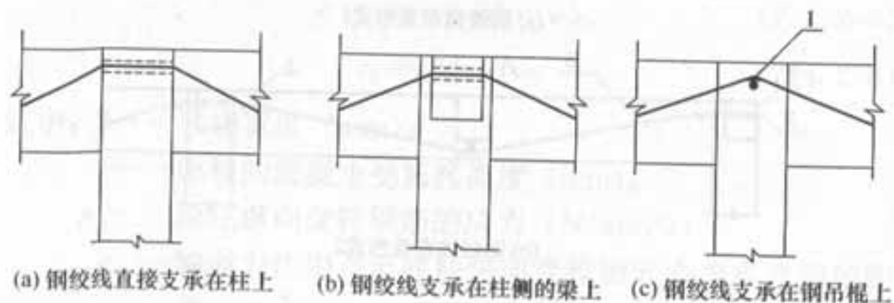
图 7.5.2 中间连续节点构造方法
